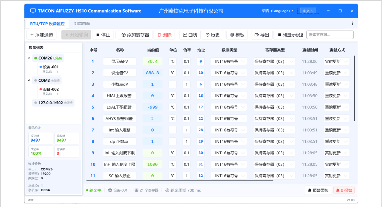
图 2-1软件主界面（RTU/TCP 设备监控页）
