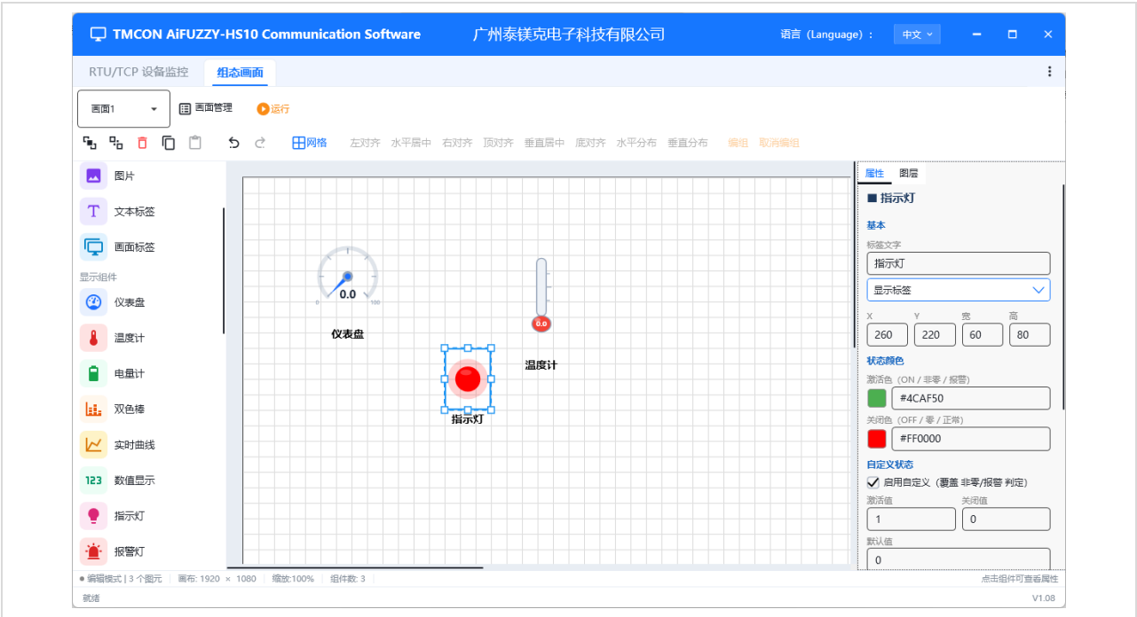
图 4-3 指示灯属性面板——状态颜色、自定义状态、激活闪烁
