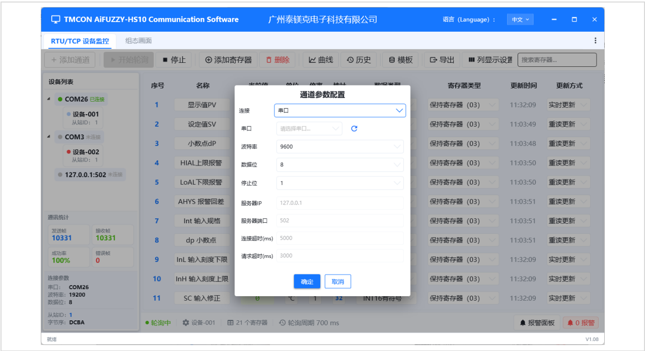
图 3-1添加通道 -- 串口 (Modbus RTU) 参数配置
