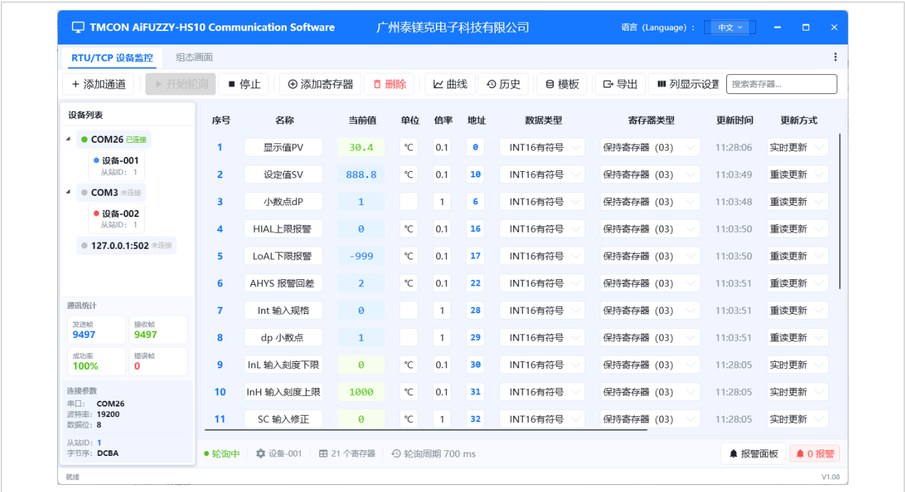
图 3-8 轮询运行中：设备列表显示绿色在线圆点，状态列显示“正常”，超限数值以红色高亮
