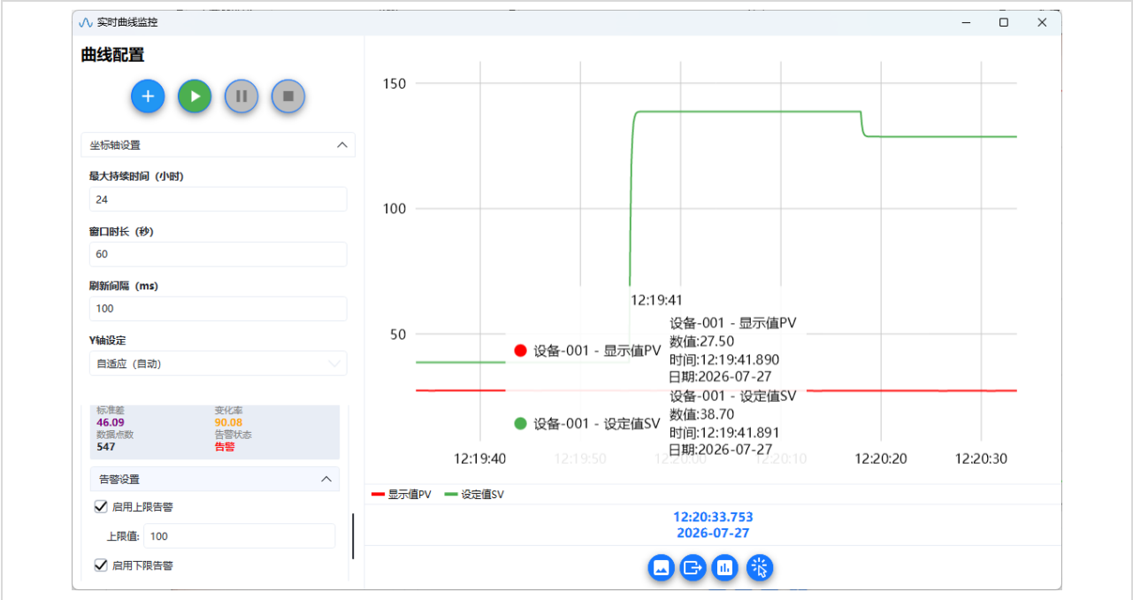
图 3-12曲线窗口中的单点统计信息与告警设置 (启用上限/下限告警)
