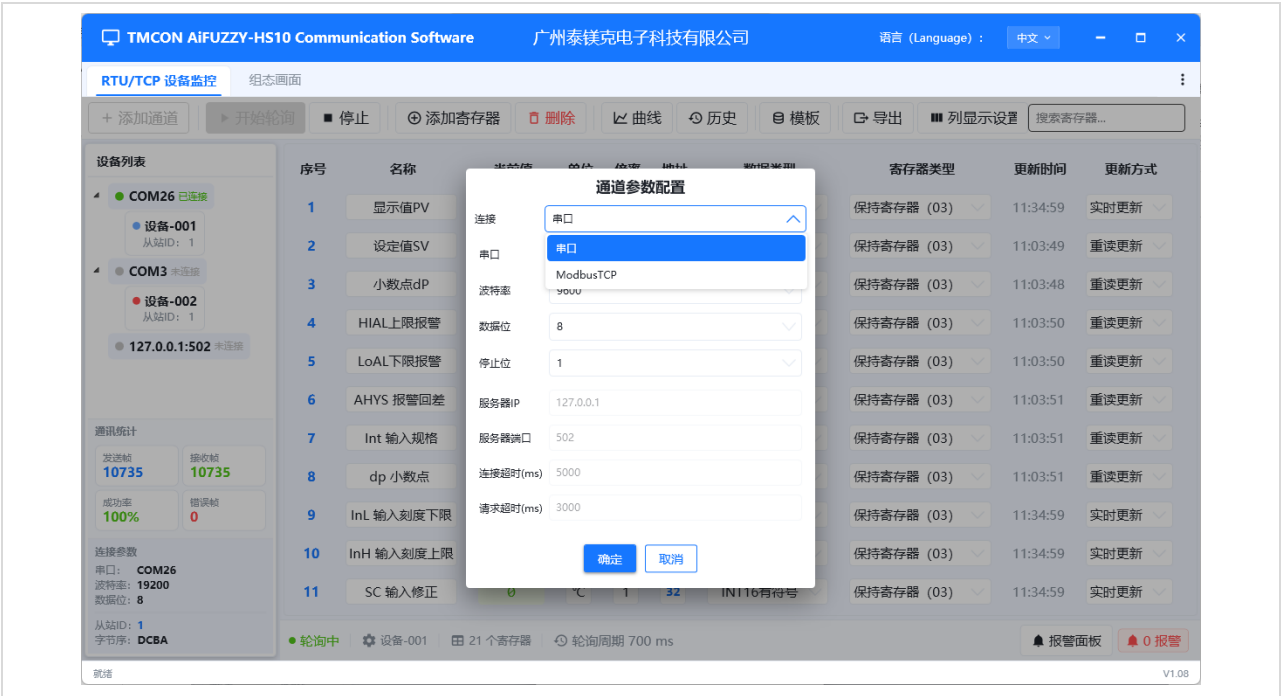
图 3-2添加通道 -- 网络 (Modbus TCP) 参数配置
