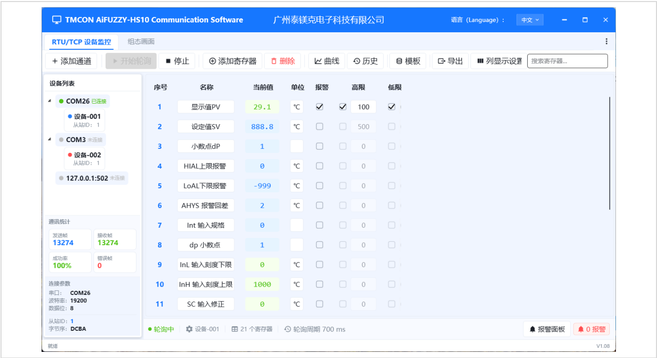
图 3-7寄存器表格右侧列--写入值 / 操作 / 启用 / 报警 / 高限 / 低限（可拖动表格底部滚动条查看）
