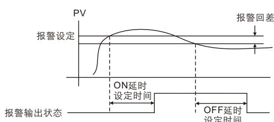
接通电源报警ON 延时也生效。报警ON 的区间为ON 延时设定以下时，报警输出不会ON。同样，报警OFF 的区间为OFF 延时设定以下时，报警输出不会OFF。
