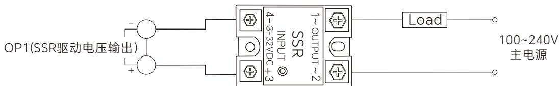
● 可控硅触发输出 (OUT端口安装K1、K5、K6模块)
